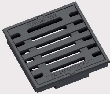
Hofaufsatz A15 Pultform 30/30 cm, Schlitzweite 16 mm Guss/Guss
